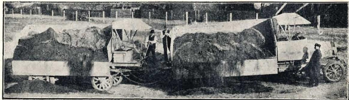
Fig. 4. — Doppio autocarro per trasporto di terra («Motor», 1914).
