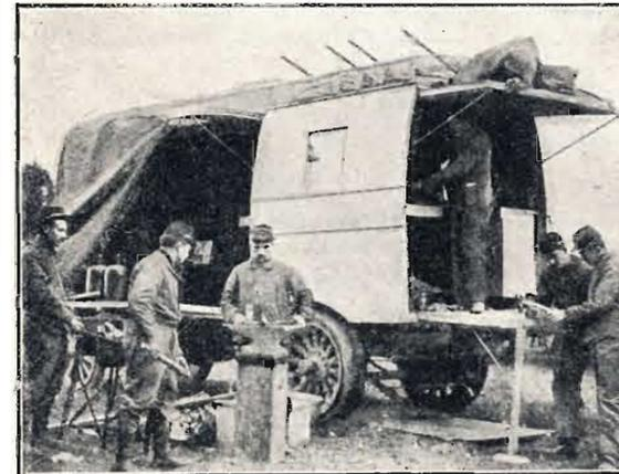
Fig. 1. — Automobile per riparazioni meccaniche («Illustrierte Zeitung», 1912).
